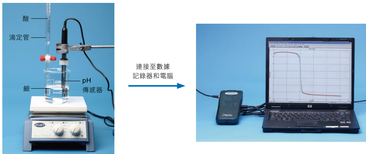
圖16.9 (a) 當酸加入鹼時，用作量度溶液pH值的變化的儀器和實驗裝置。(b) 數據記錄器收集的數據可經電腦軟件分析，並製成圖表。
