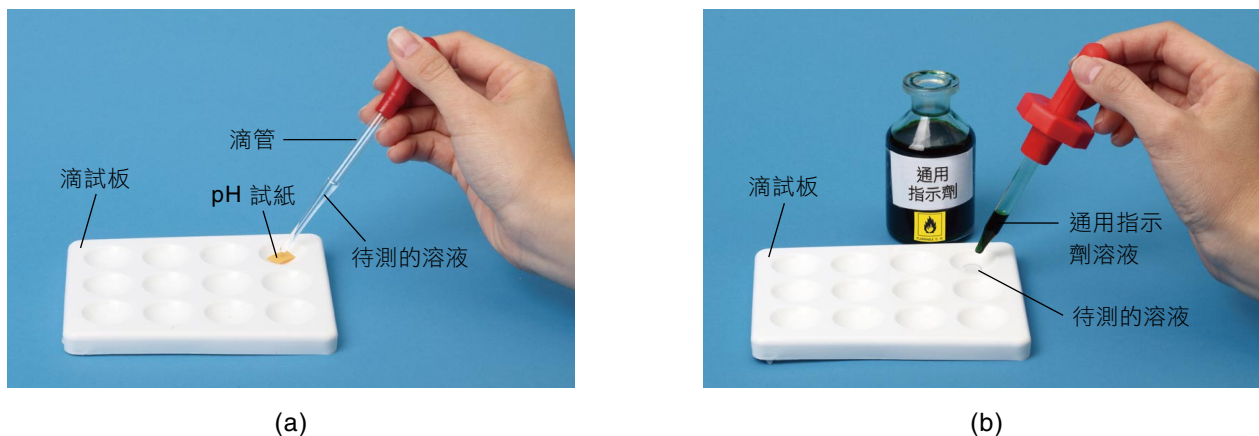
圖16.7 利用 (a) pH試紙和 (b) 通用指示劑溶液來測定溶液的pH值。
