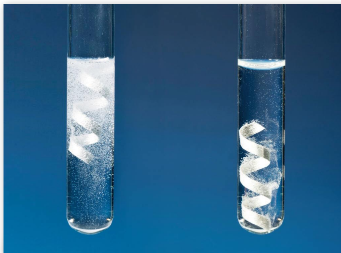
1.0 M氫氯酸(左)和1.0 M乙酸(右)與相同質量的鎂帶的反應。
