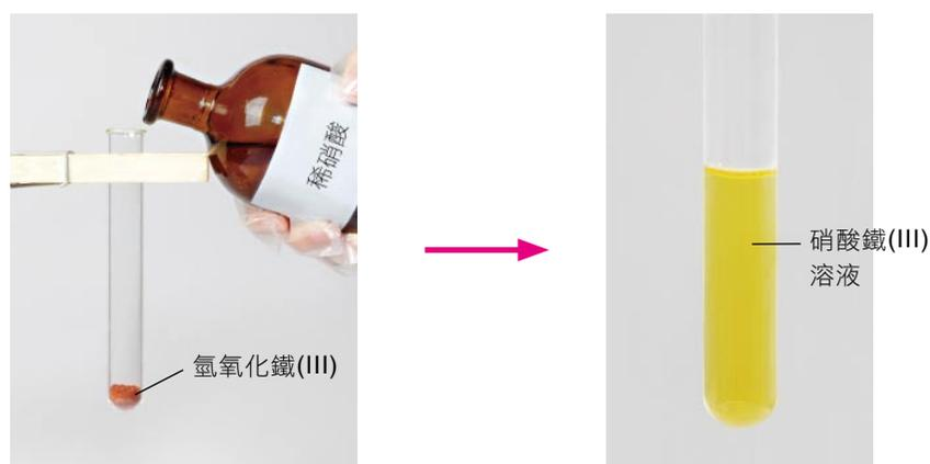
圖18.2 稀硝酸與氫氧化鐵(III) 反應，生成硝酸鐵(III) 和水。
