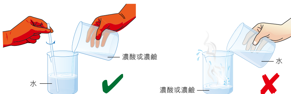
圖14.31 稀釋濃酸和濃鹼時的正確步驟。
