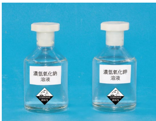
圖14.29 盛有濃氫氧化鈉溶液和濃氫氧化鉀溶液的試劑瓶貼上「腐蝕性」的危險警告標籤。
