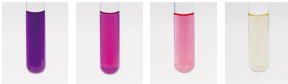
圖36.10 \text{MnO}_4^- (aq)和 \text{C}_2\text{O}_4^{2-} (aq)的反應混合物的顏色深度隨時間下降。
